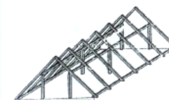
Obr. 2.84 Vážnicový krov so strednými väznicami
