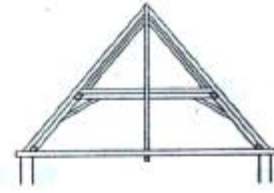
Obr. 2.103 Hambáľkový krov s dvojitou ležatou stolicou a vešadlom
