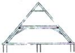
Obr. 2.102 Hambáľkový krov s dvojitou stojatou stolicou stúženou pásikmi
