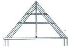
Obr. 2.104 Hambáľkový krov so vzperami rovnobežnými s krokvmi a s vešadlom
