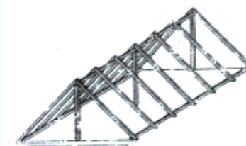
Obr. 2.83 Vážnicový krov s vchodovou hrebeňovou stĺpcou a pomôcnicou
